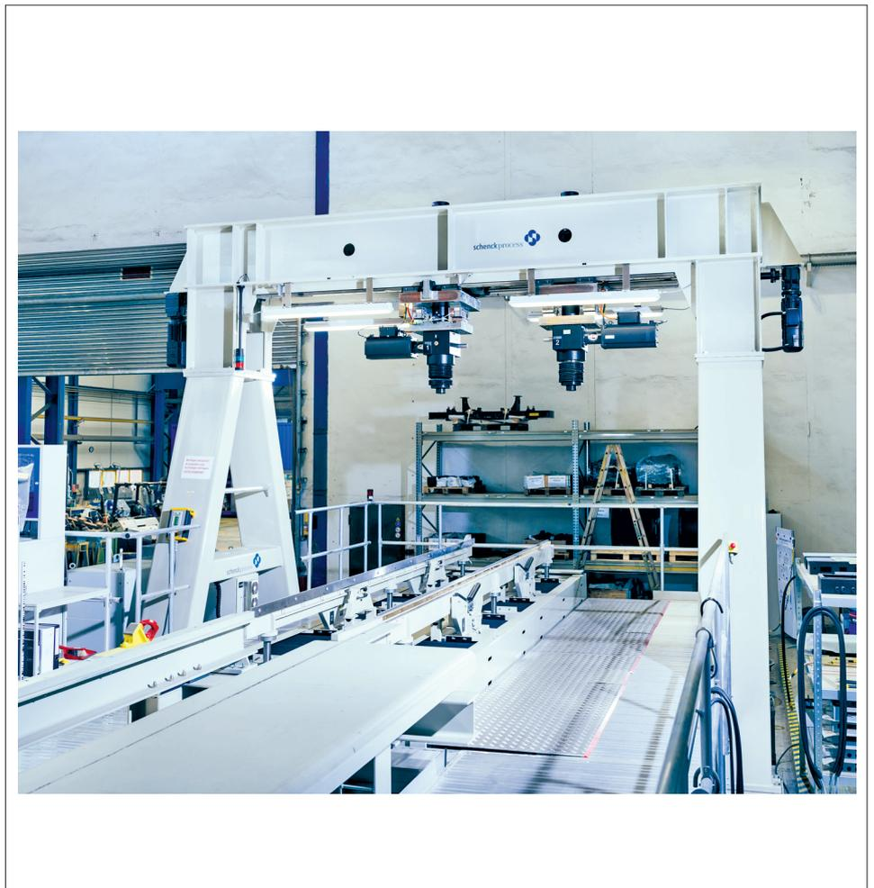
Drehgestell Prüfstand / bogie test bench
